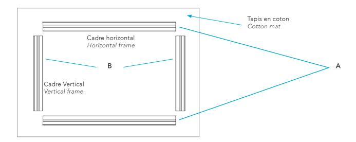
Insérez les plaques d'écrous dans les rainures.
