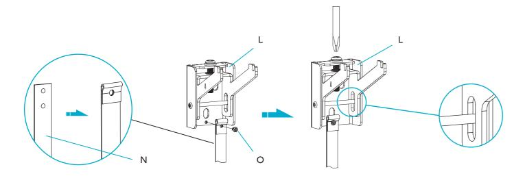
Vissez les extrémités des sangles aux supports (M) (voir étape 10). Screw the ends of the straps to the (M) brackets (see step 10).
