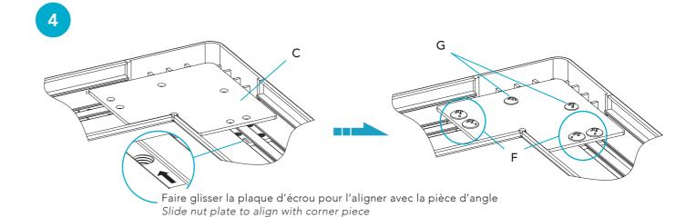
Vérifiez que les éléments sont correctement alignés, faites des ajustements si nécessaire. Check all parts are properly aligned, and make adjustments if needed.
