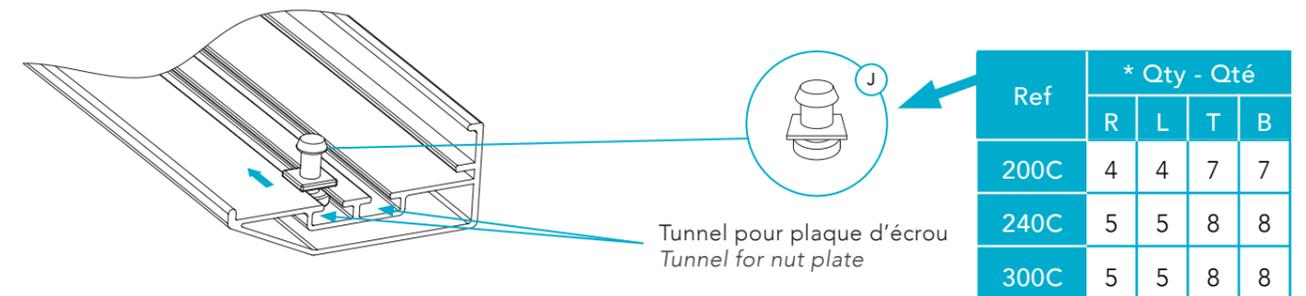
**3** Insérez les plaques d'écrous dans les rainures.
